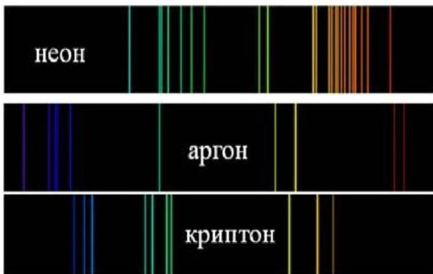
Мы видим множество цветных линий, разделенных широкими темными полосами. Наличие линейчатого спектра означает, что вещество излучает свет только вполне определенной длины волны.
