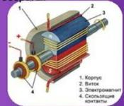
Одной из функций генератора является подзарядка аккумуляторной батареи при работающем двигателе. В электрическую цепь генератор включается параллельно аккумуляторной батарее
