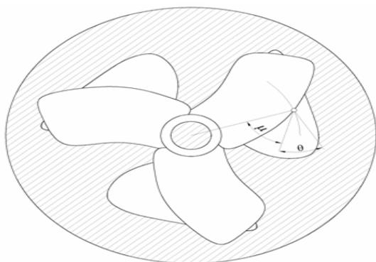
В гидротехнике по логарифмической спирали заворачивают трубу, подводящую ток воды к лопастям турбинного колеса. Постоянство угла  $\mu$  обеспечивает здесь то, что потери энергии на изменение, и, следовательно, напор воды используется с максимальной производительностью.
